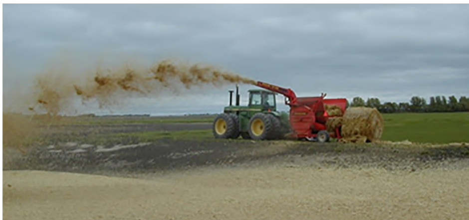
Broyeur de paille installant une couverture de paille perméable sur un entreposage de lisier.
