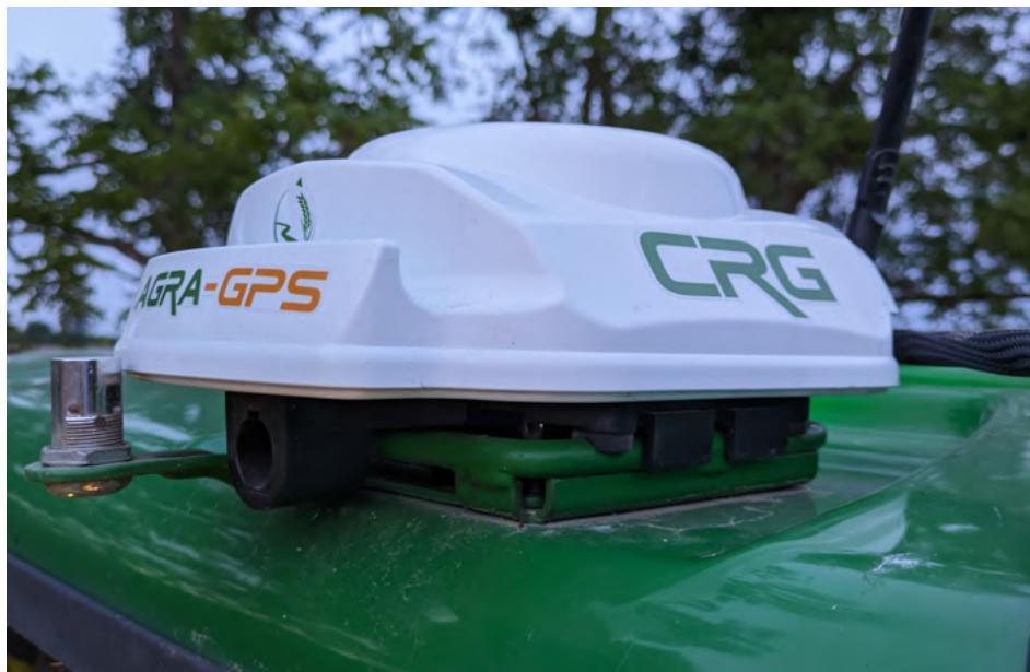
Bien que certains opérateurs continuent d'utiliser un marqueur en mousse à l'extrémité de la rampe pour limiter les manques et les chevauchements, la technologie GPS avec autoguidage utilisée conjointement avec un contrôle individuel ou sectionnel de la buse assure une pulvérisation beaucoup plus précise.
