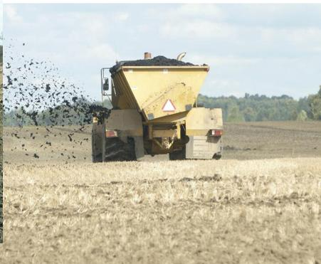
L'épandage de biosolides déshydratés peut être fait au moyen de matériel d'injection spécialisé ou d'un épandeur à fumier solide adapté.
