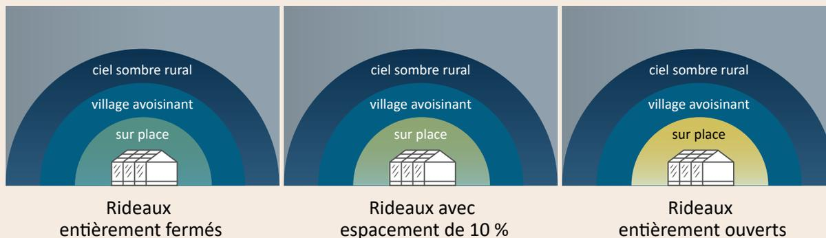
**Figure 2.** Luminosité moyenne du ciel nocturne mesurée à partir d'un capteur de lumière (indicateur de la qualité du ciel) monté sur une voiture et dirigé vers le haut avec des rideaux de serre occultants ouverts à 0 %, 10 % et 100 %, comparativement à la luminosité moyenne mesurée dans un ciel nocturne sombre rural ou un village avoisinant. Aucun changement important n'a été observé dans la luminosité du ciel nocturne sombre rural ou village avoisinant pour tous les scénarios.
