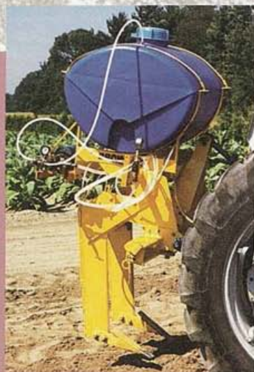
Une nouvelle méthode de fumigation fait usage d'une sous-soleuse à deux étançons pour placer le produit chimique dans une bande étroite à trois profondeurs.
