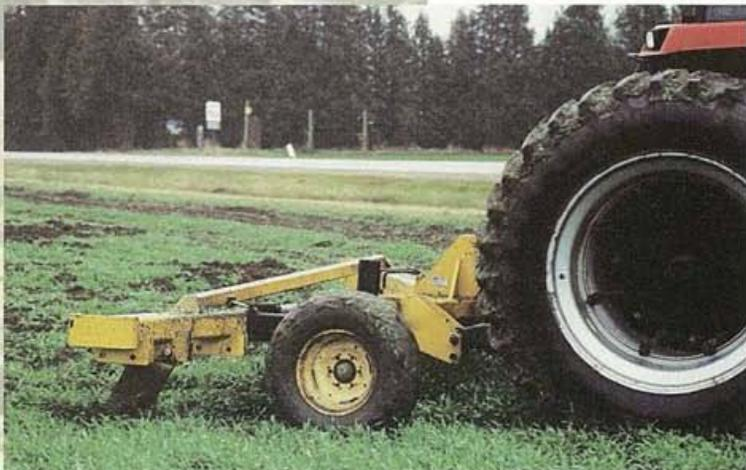
**Le sous-solage ou le passage d'une charrue chisel dans une culture de plante couvre-sol peut détruire la semelle de labour. Le sol doit être sec et on laisse assez de résidus à la surface pour prévenir l'érosion.**
