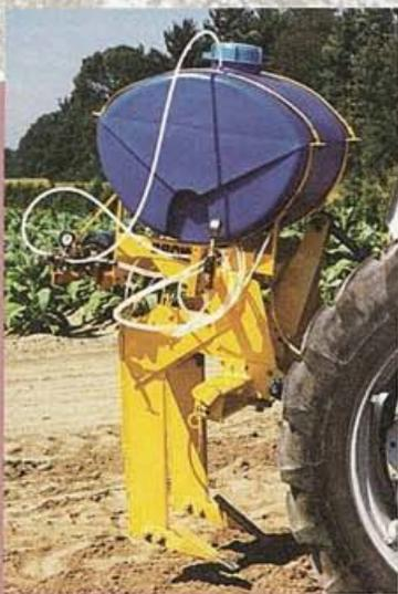
Une nouvelle méthode de fumigation fait usage d'une sous-soleuse à deux étauçons pour placer le produit chimique dans une bande étroite à trois profondeurs.
