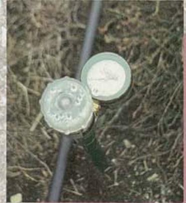
Le tensiomètre est un outil valable pour déterminer quand irriguer. Une méthode alternative consiste à baser l'horaire d'irrigation sur la capacité de rétention de l'eau dans le sol et les pertes d'eau dues à l'évapotranspiration de la culture.
