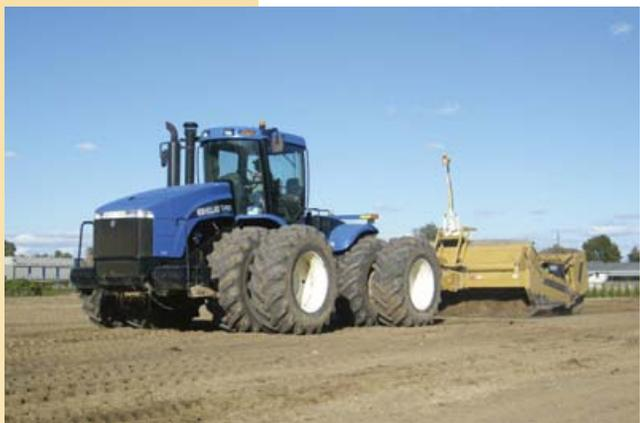
**Le nivellement d'une terre n'est pas considéré comme une PGO. Il consiste à atténuer les buttons et à combler les dépressions, sans toutefois modifier la pente générale d'un champ. L'eau descend le long de la pente avec moins de résistance.**
