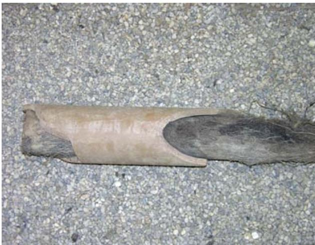
Un drain de 100 mm (4 po) contenant 20 mm (3/4 po) de sédiments verra son débit baisser à 80 % de sa capacité normale. Avec 30 mm (1 po) de sédiments, sa capacité sera réduite à 65 % de sa capacité.
