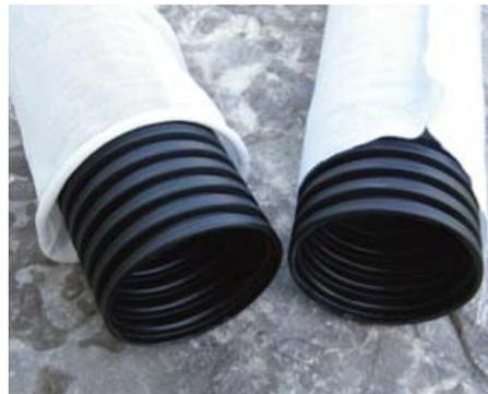
Les matériaux filtrants appelés géotextiles non tissés ou membranes filtrantes tricotées sont couramment utilisées comme enveloppes synthétiques enrobant le drain au sortir de l'usine. Ces matériaux peuvent être faits de polyester, de polypropylène, de polyamide, de polystyrène ou de nylon. Les matériaux filtrants peuvent réduire la charge de sédiments dans le drain, mais il n'existe pas de textile passe-partout convenant à tous les sols problématiques.
