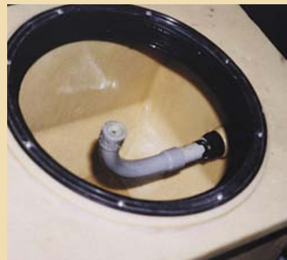
Ce dispositif, s'il est fixé à un pulvérisateur de grande culture, permet au producteur de soumettre les contenants à un triple rinçage, puis de diriger l'eau de rinçage immédiatement dans le réservoir.
