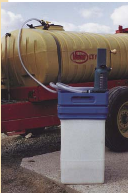
Cette pompe à main volumétrique peut aider les producteurs à ajouter des volumes précis et à éviter les éclaboussures et les déversements.
