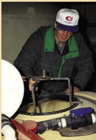
Un dispositif anti-retour peut être aussi simple et aussi efficace que l'invention de cet agriculteur. La modification du pulvérisateur est placée au-dessus de l'ouverture du réservoir et le tuyau est lié au dispositif pendant le remplissage.
