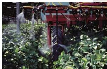
**TYPE DE JET.** Pour atteindre la cible, il faudra peut-être utiliser une buse à type de jet différent (p. ex. buse à jet dirigé dans le ginseng pour lutter contre les maladies du feuillage).
