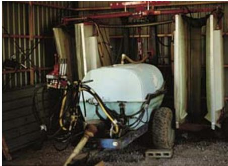
Les pulvérisateurs à recyclage diminuent la dérive et rendent l'appareil plus efficace car la bouillie de pulvérisation est recyclée à l'aide des parois et des rigoles.
