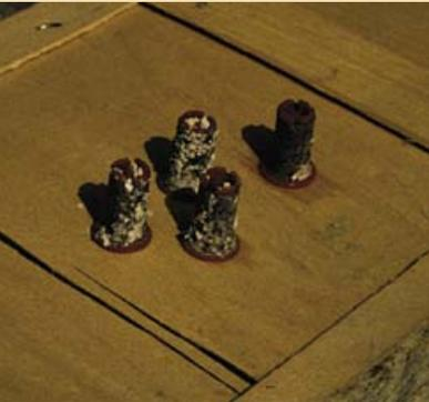
Les filtres suivants sont nécessaires pour protéger les composantes et diminuer l'obstruction : à l'entrée du réservoir, au bout de la conduite, à l'intérieur de la conduite (facultatif) et dans la buse.
