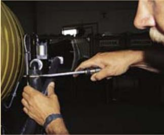
Démontez régulièrement le régulateur de pression afin de vérifier les composantes internes. Remplacez les pièces usées (comme les pistons).
