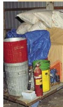
Cette trousse de lutte contre les déversements, de fabrication domestique, contient des matériaux rapidement et facilement utilisables pour endiguer, retenir, absorber et éliminer les matériaux contaminés d'un déversement.
