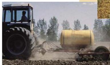
**CULTURES EN LIGNE.** Dans les traitements de présemis, la cible est la surface du sol. Utilisez une buse formant un jet à faible pression à grosses gouttelettes (buses à miroir ou à jet plat rectangulaire)
