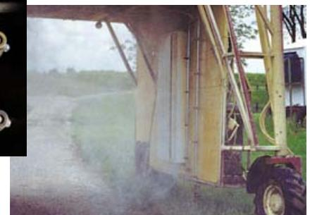
Les pulvérisateurs encapuchonnés et les déflecteurs peuvent diminuer la dérive et permettre un dépôt sélectif.
