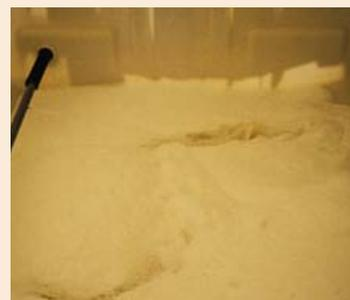
Dans l'agitation hydraulique, une série de buses ou de jets pousse le liquide dans le réservoir, ce qui le remue et le mélange.
