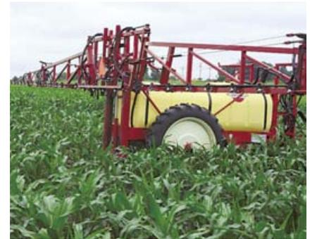
Ces rampes mobiles sont dotées d'un mécanisme qui les garde à hauteur uniforme même si la hauteur du réservoir change sur un terrain accidenté.
