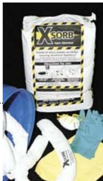
Il existe aussi des trousse de lutte contre les déversements qui comprennent du matériau absorbant et de l'équipement de sécurité.
