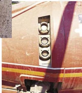
Les pulvérisateurs à détection des arbres se servent de la réflexion de la lumière pour sentir la présence des arbres dans leurs déplacements dans un verger.
