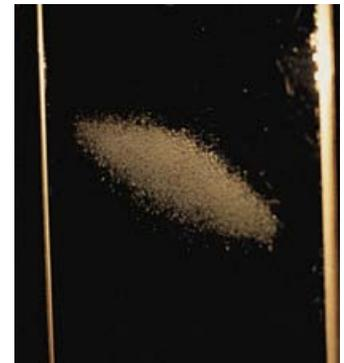
Les buses à jet plat montées sur une rampe servent à appliquer les pesticides à faible pression.
