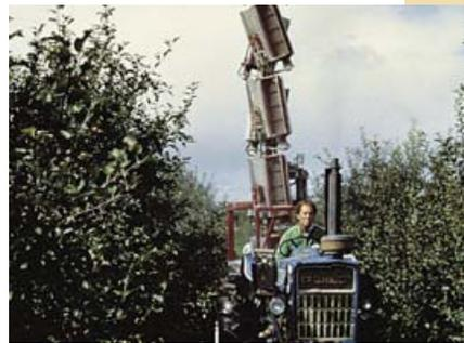
Les pulvérisateurs à rideau d'air comprennent des compartiments de buses et des bras hydrauliques afin de diminuer la distance entre les buses et la cible et d'améliorer la pénétration sous le couvert végétal.
