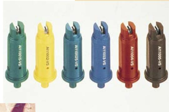
Les embouts d'admission d'air laissent pénétrer de l'air afin de diminuer la pression et d'augmenter la taille des gouttelettes. Ils font diminuer la dérive et assurent un meilleur épandage.
