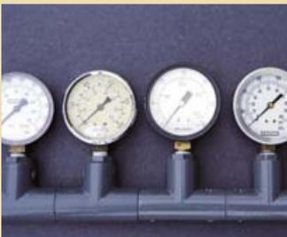
Si l'aiguille du manomètre tressaute, comparez avec celle d'un manomètre en bon état. Vérifiez le fonctionnement du modérateur de pulsation.
