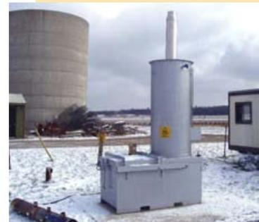
Pour être efficace et sécuritaire, un incinérateur doit permettre une combustion secondaire.
