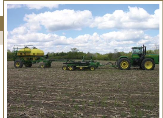
Les systèmes de semis qui perturbent peu les sols réduisent significativement les risques d'érosion résultant du travail du sol et des fortes pluies.
