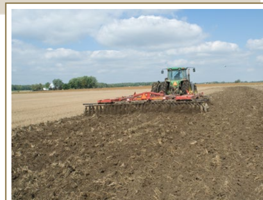
Régler les instruments de travail du sol et les surveiller pendant l'utilisation pour éviter qu'ils attaquent le sous-sol.
