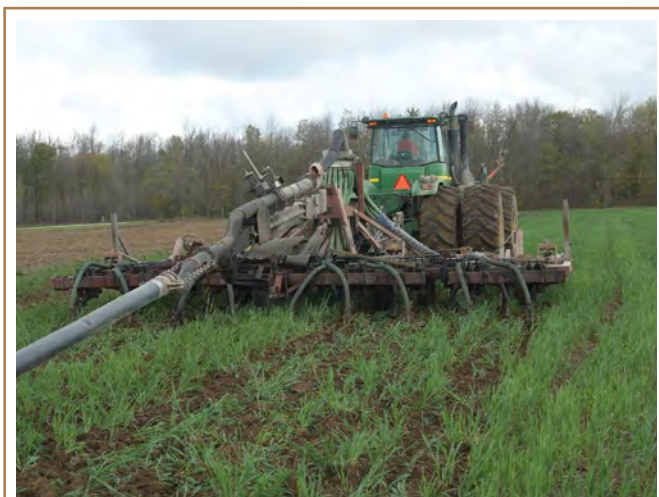
Pour prévenir un déversement, l'opérateur d'un système à écoulement direct doit pouvoir l'arrêter à tout moment.
