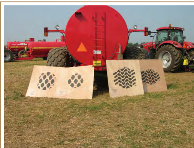
Lorsque les pneus des véhicules d'épandage sont gonflés à faible pression, la surface de contact avec le sol s'accroît, ce qui contribue à diminuer le risque de compactage.
