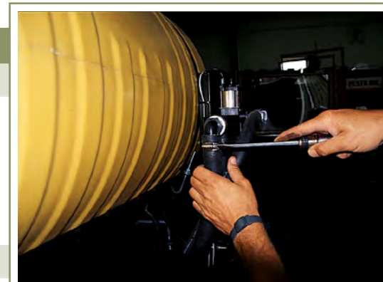
Entretien et étalonnage du matériel de pulvérisation et d'épandage de granules avant le début de chacune des saisons de croissance.
