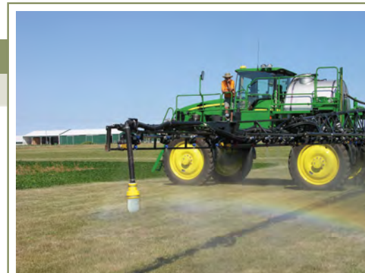
Un marqueur en mousse à l'extrémité de la rampe indique la lisière de la pulvérisation et assure une couverture uniforme, sans trop de chevauchements.
