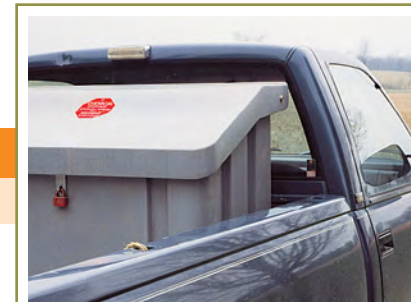
Un panneau d'avertissement doit être placé dans le véhicule lorsque ce dernier transporte plus de 500 L de pesticides. Le panneau doit aussi être affiché sur les véhicules contenant des pesticides lorsque les véhicules sont laissés sans supervision.
