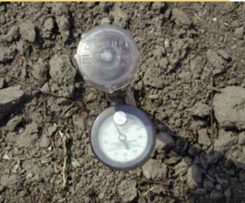
Le tensiomètre convient le mieux dans les sols sableux.
