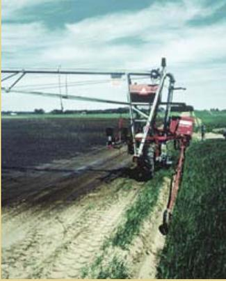
Très similaire au système à pivot central au plan mécanique, le système à déplacement latéral se distingue du fait que la conduite secondaire se déplace de côté à travers le champ et irrigue une parcelle rectangulaire.
