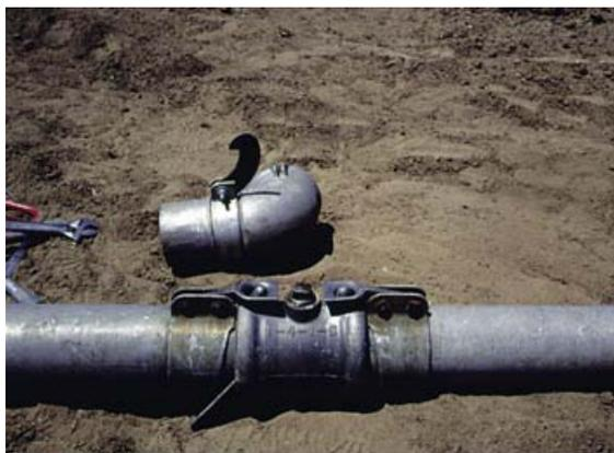
**Un des avantages du raccord de type bouton et loquet est que l'eau s'échappe facilement des tuyaux séparés, ce qui facilite le déplacement du matériel.**
