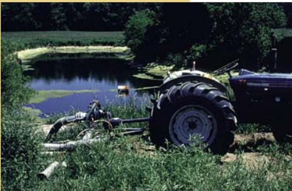
La pompe entraînée par la prise de force du tracteur permet de faire un bon usage des sources d'énergie existantes.
