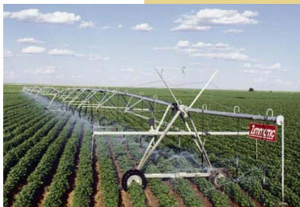
Ce système avec tubes de descente à faible pression permet d'utiliser l'eau plus efficacement.
