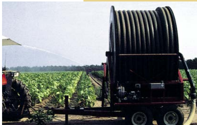
Un treuil ou un enrouleur tire le canon monté sur une structure. Ce dernier irrigue le champ en se déplaçant.
