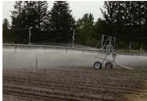
Nombre de producteurs utilisent désormais des systèmes à rampes, lesquels réduisent les pertes d'eau dues à l'évaporation et au vent.
