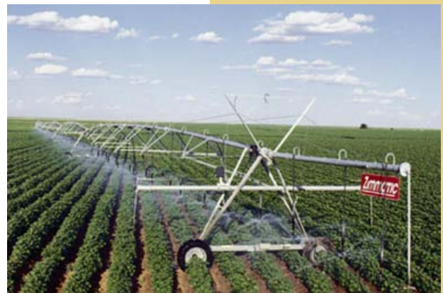
Ce système avec tubes de descente à faible pression permet d'utiliser l'eau plus efficacement.
