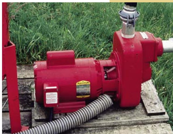
Cette pompe électrique de 3 hp alimente un système d'irrigation goutte-à-goutte.
