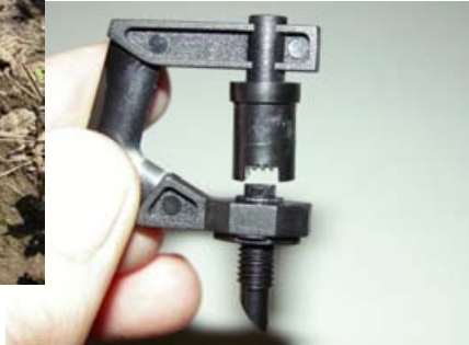
Ce diffuseur à microjet ne comporte aucune pièce mobile et peut s'insérer dans le tuyau.
