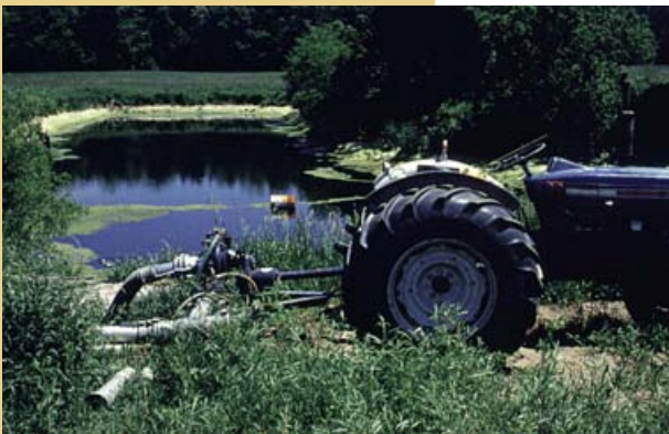
La pompe entraînée par la prise de force du tracteur permet de faire un bon usage des sources d'énergie existantes.
