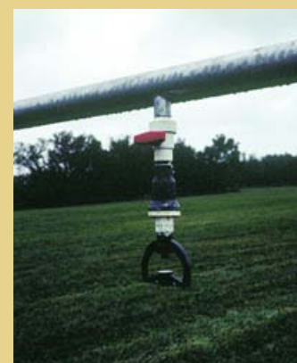
Les systèmes à faible pression distribuent l'eau en fines gouttelettes, convenant ainsi à l'irrigation des cultures fragiles.
