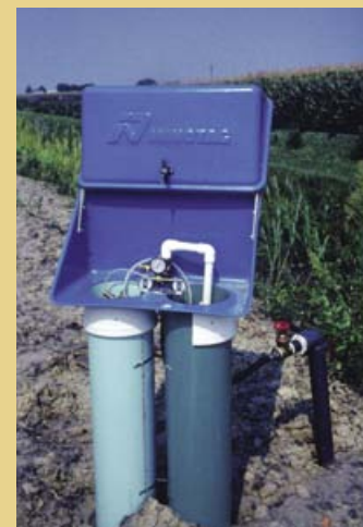
Dispositif vendu sur le marché pour contrôler l'apport d'eau dans un système d'irrigation souterraine par le réseau de drainage.
