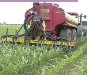
L'injection du fumier liquide sous la surface du sol élimine pratiquement toutes les odeurs.
