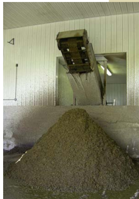
La séparation des solides et des liquides facilite le pompage et l'application de la fraction liquide.
