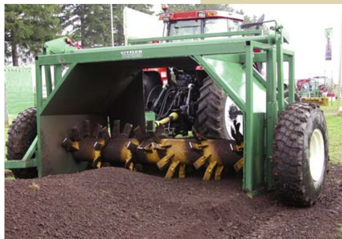
Les composteurs d'andains permettent d'accélérer le processus de compostage.
