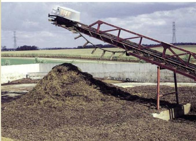
Les convoyeurs empileurs de fumier et les écuriers d'étable conviennent bien aux étables à stabulation entravée quand on récolte les eaux de ruissellement dans une structure d'entreposage distincte.
