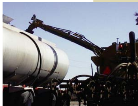
Les bras de chargement sous vide sont utiles pour décharger les réservoirs de ravitaillement. Il est recommandé de les inclure lorsque c'est possible dans les plans d'urgence, en cas de déversement.
