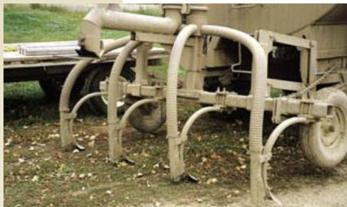
La technique d'injection de faible perturbation peut être utilisée dans les systèmes de semis direct, pour l'épandage en bandes latérales dans les cultures de céréales et entre les coupes de cultures fourragères.
