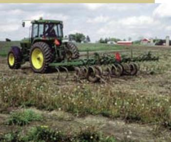
Un travail préalable du sol avant l'épandage de fumier liquide facilite l'absorption.
