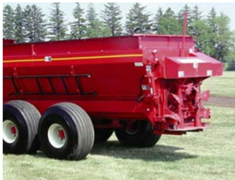
Les épandeurs centrifuges montés sur des épandeurs à caisson sont conçus pour épandre les fumiers secs et les composts plus uniformément dans le champ. Certains épandeurs sont aussi conçus pour épandre de très bas volumes.
