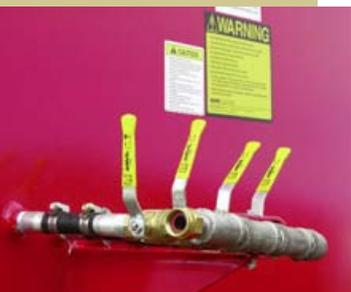
Sur certaines citernes, un système de lavage est installé au point d'admission, ce qui prolonge la durée de l'équipement et réduit le risque d'accumulation des gaz létaux.
