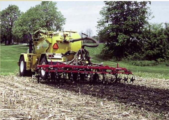
**Les possibilités d'incorporation offertes par le matériel d'épandage influencent considérablement les pertes d'azote. Les pertes d'ammonium sont minimales si le fumier est immédiatement incorporé au sol. Les pertes les plus grandes se produisent par temps chaud et ensoleillé, tandis que les conditions fraîches et nuageuses sont associées aux pertes les moins importantes.**
