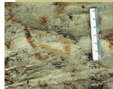
Les sols dans lesquels on trouve des tons bleu-gris et des taches de rouille dans les 50 premiers centimètres (20 po) ont une nappe phréatique élevée et souffrent d'un drainage médiocre.
