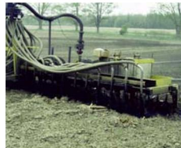
Les aérateurs, conçus pour percer des trous dans le sol, facilitent l'infiltration des liquides. Ils s'utilisent bien dans les cultures sur pied s'ils sont modifiés pour travailler les entre-rangs. Un inconvénient de cet outil est qu'il augmente le risque de compactage des sols détrempés ou à texture fine.
