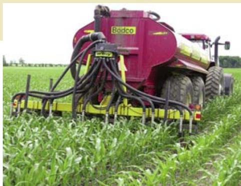
Le fumier peut être épandu par aspersion en bandes latérales dans une culture en rang sur pied, puis incorporé au sol au moment du passage de l'extirpateur destiné à arracher les mauvaises herbes.
