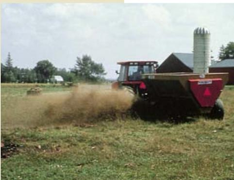
**Pour améliorer l'uniformité d'application avec un épandeur à déchargement latéral, déterminer le chevauchement nécessaire et ajuster en conséquence la distance entre les bandes recevant le fumier.**
