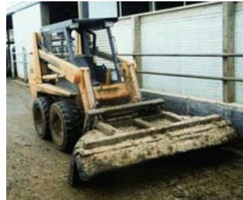
L'ajout d'une arête de bois ou de caoutchouc sur la lame de la décapeuse peut réduire l'usure du plancher.
