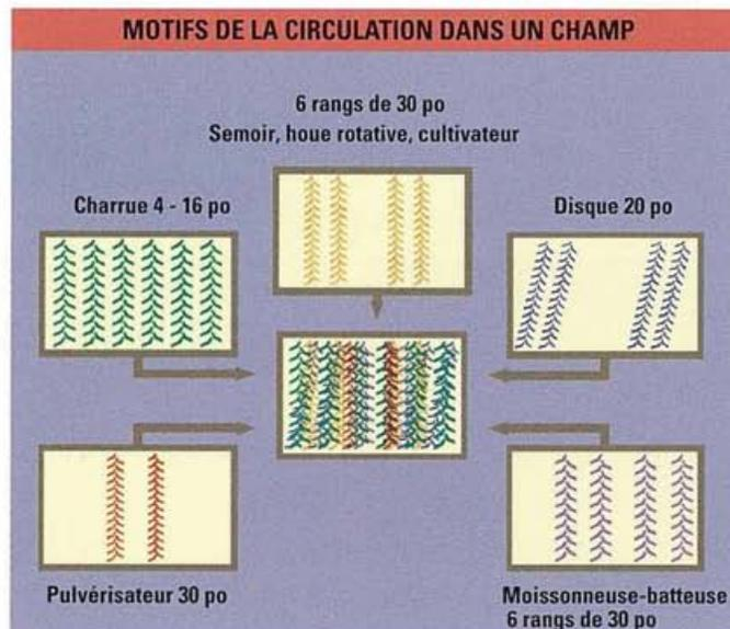
Quelle proportion du champ est couverte de traces de pneus durant une année? La réponse est souvent 90 pour cent pour les champs à drainage conventionnel. Voici le motif des traces de pneus de tracteur au cours de la préparation traditionnelle du lit de semence. Il s'agit d'une condition idéale où l'équipement est rattaché au tracteur et où le nombre de passages aratoires est assez bas.
