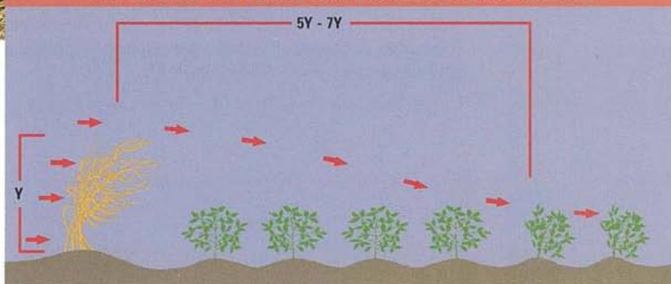
Il existe plusieurs façons de lutter contre le vent. Les rideaux-abris d'herbages offrent une protection semblable à celle des arbres brise-vent. Cependant, l'herbe est plus flexible et peut être couchée par les vents forts, ce qui diminue la surface protégée.
