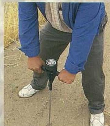
Les pénétromètres servent à estimer la résistance du sol et à évaluer les diverses réactions aux traitements expérimentaux. Les pénétromètres donnent une bonne estimation si on les utilise correctement; une sonde tubulaire flexible peut également très bien convenir, surtout dans les champs. Voir «Repérage du compactage», page 36.
