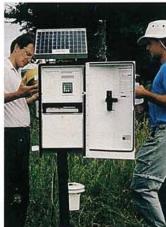
Les données météorologiques jouent un rôle clé dans la stratégie de lutte intégrée. Cet appareil sert à prévoir les risques de brûlure alternarienne et de mildiou dans les cultures de pommes de terre.
