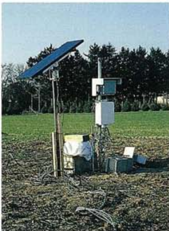
Cette station météorologique à pile solaire sert au contrôle des conditions météorologiques dans un champ de légumes.
