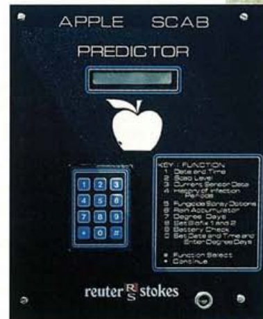
Il existe dans le commerce des appareils de prévision des risques de maladie. Celui-ci mesure le taux d'humectation des feuilles et la température, et nous avertit de l'arrivée de conditions propices à la tavelure des pommes.
