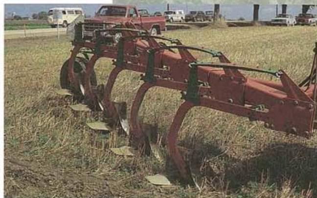
La modification de la charrue à versoirs augmente la couverture de résidus.
