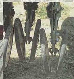
Les roues plombeuses les plus courantes sont les roues de caoutchouc larges (à gauche) et les roues en V (à droite). Le choix de l'un ou l'autre modèle dépend du sol et des conditions au moment des semis.
