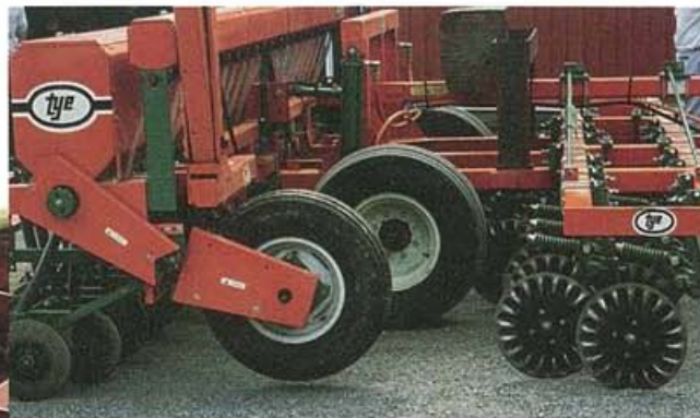
Semoir muni d'une barre porteuse de coutres pour le semis direct.
