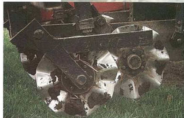
Les coutres sont déportés afin de permettre un meilleur écoulement des résidus.
