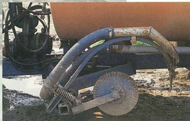
Des coutres sont installés à l'avant des injecteurs pour couper les résidus.
