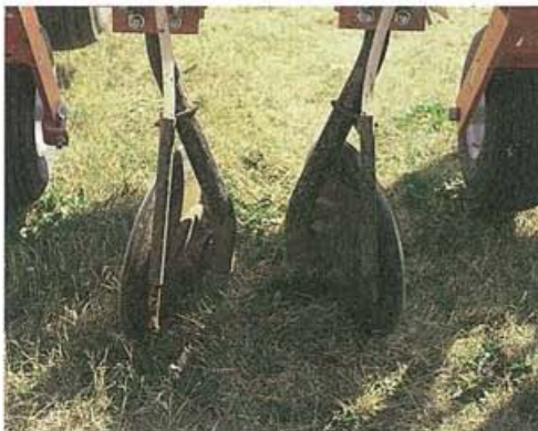
Les disques buteurs de ce cultivateur sont munis de tubes pour l'application d'azote liquide.
