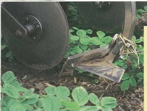
Une pointe de travail profond améliore la pénétration des socs.
