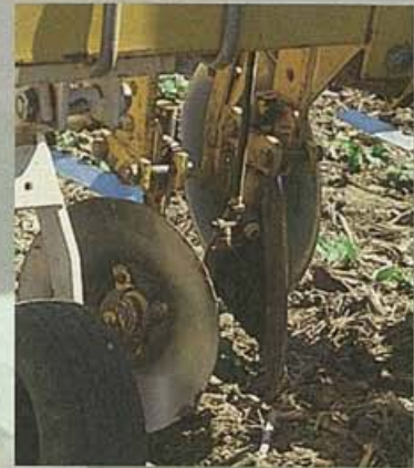
Les buses pour traitement en bande permettent un arrosage localisé sur le rang.
