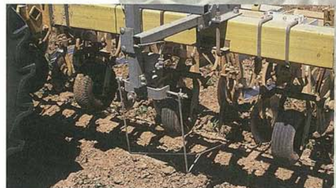
Tiges sensorielles d'un système de guidage automatique.
