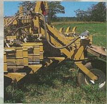
Les buses pour traitement en bande permettent un arrosage localisé sur le rang.
