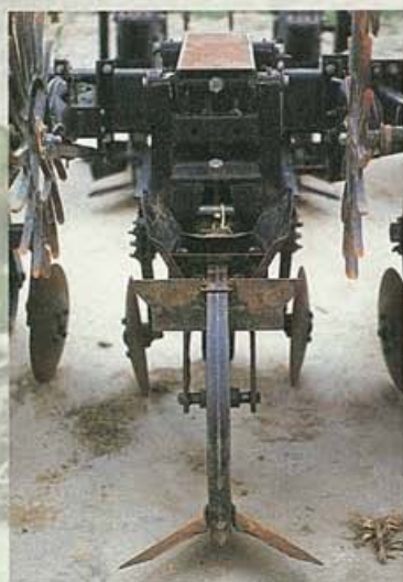
Soc et disques buteurs d'un cultivateur de billons.
