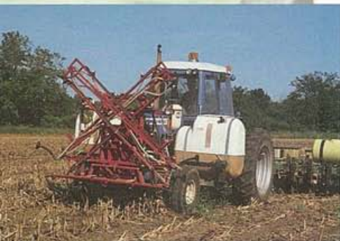
Une rampe de pulvérisateur montée à l'avant du tracteur permet les traitements localisés.
