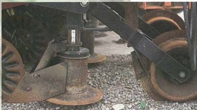
Décapeurs de billons attachés à l'avant d'un planteur traditionnel.
