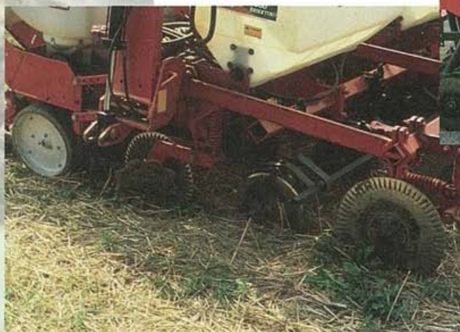
Des coutres et des déblayeurs de rang furent ajoutés à ce planteur.
