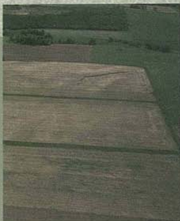
Vue aérienne de deux terrasses parallèles à base étroite avec puisards. Conçues pour raccourcir la pente, la terrasse réduit l'érosion jusqu'à 75 % et permet une rotation plus intensive des cultures.
