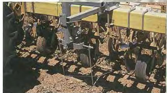
**Tiges sensorielles d'un système de guidage automatique.**
