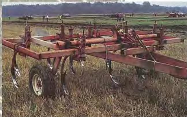
Il existe différents modèles de charrues chisel. En voici un sans disques ni coutres à l'avant.
