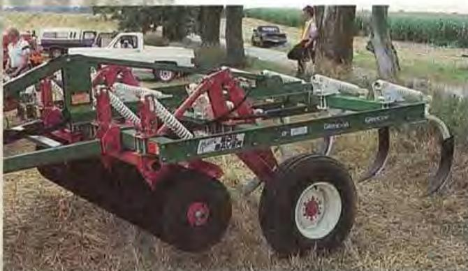
Cette charrue chisel est pourvue d'une série de coutres devant les chisel en patte d'oie.
