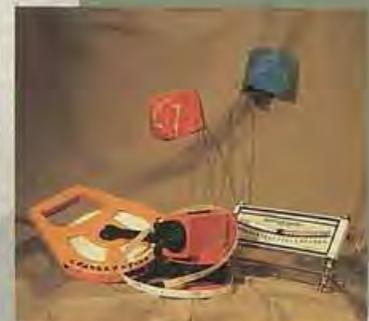
Plusieurs outils peuvent servir à installer des cultures en bandes isohypses. Ils comprennent des niveaux ou des jauges de courbes de niveau et des rubans à mesurer.
