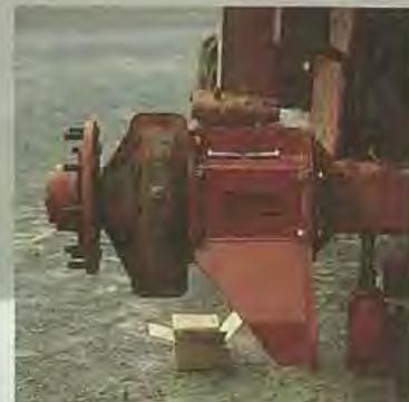
L'ajout d'écarteurs à la moissonneuse-batteuse permet la circulation dans l'entre-rang.
