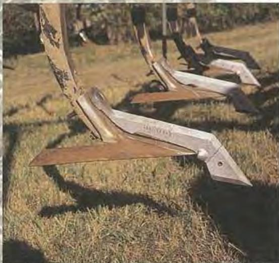
Une pointe de travail profond sur le soc en patte d'oie peut aider le chisel à pénétrer dans un sol compacté dont la structure est faible.
