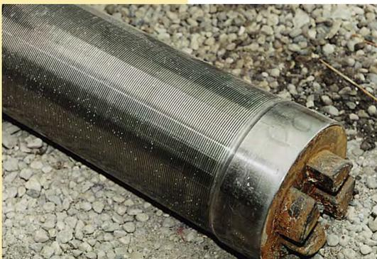
Voici un filtre de puits en acier inoxydable. Il sert à retenir les sédiments dans l'aquifère tout en laissant l'eau monter dans le tubage du puits.
