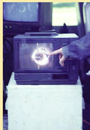
On peut descendre un caméscope spécial dans le tubage du puits afin que des spécialistes examinent les conditions réelles à diverses profondeurs. On peut alors examiner le tubage et le filtre et déterminer le débit.
