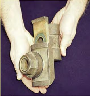
Les adaptateurs de branchement à coulisseau installés dans le tubage, sous le niveau de pénétration du gel, permettent de relier les conduites d'eau dans le tubage. La conduite d'eau de la pompe submersible est reliée à la composante de droite, qui se glisse dans le manchon de la composante de gauche, qui traverse le tubage.
