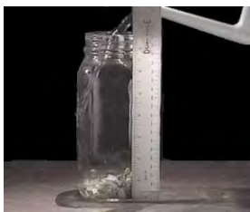
Ajout d'eau à la bentonite.
