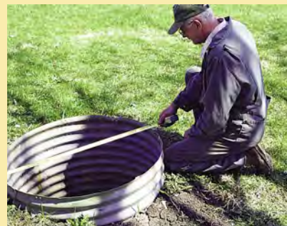
Le diamètre interne du tubage peut facilement être mesuré par le propriétaire.
