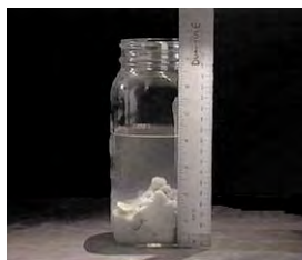
La bentonite commence à gonfler.
