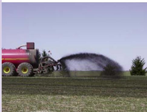
Dans le tableau ci-dessous, on trouvera une estimation des densités de fumier, afin de convertir le volume de l'épandeur en poids de fumier. À noter qu'il serait plus juste de peser plusieurs chargements ordinaires de fumier et d'utiliser ces poids dans les calculs.
