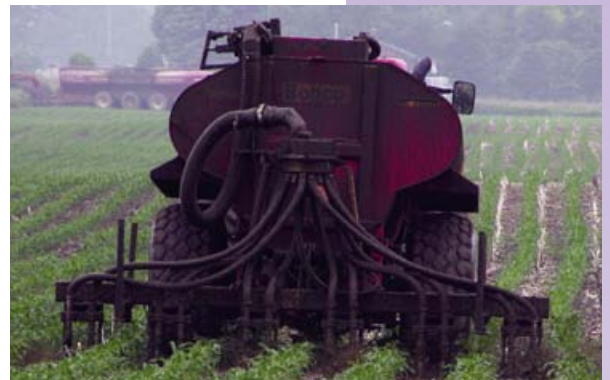
Il faut parfois modifier le matériel pour passer de l'épandage en pleine surface à la fertilisation en bandes.
