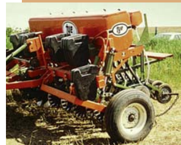
Utiliser dans la mesure du possible du matériel de semis direct, car celui-ci perturbe moins le sol et garde le carbone dans la couche arable.
