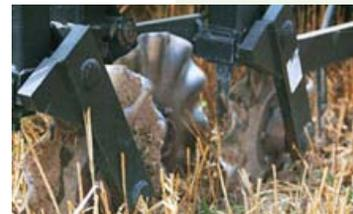
**John Munn, du comté de Huron, enlève la barre porte-outils arrière du planteur et se sert d'un système à trois coutres et sarcleuses pour travailler la paille de blé avant de planter du maïs, du soya ou des fèves blanches; il applique aussi du phosphore et du potassium.**
