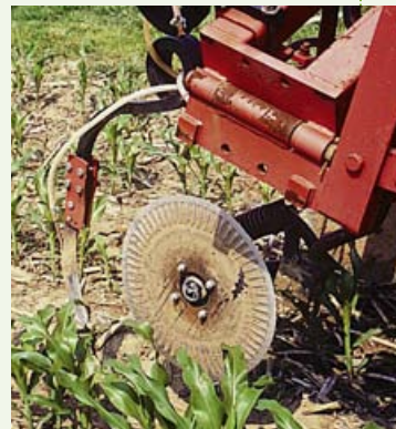
Un coultre placé devant la lame hache les résidus et améliore le dépôt d'azote.
