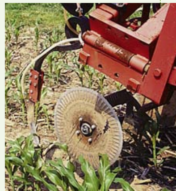
Un couteur placé devant la lame hache les résidus et améliore le dépôt d'azote.
