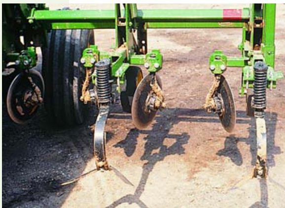
Les cultivateurs enjambeurs pour les résidus peuvent servir à la lutte contre les mauvaises herbes et au billonnage.
