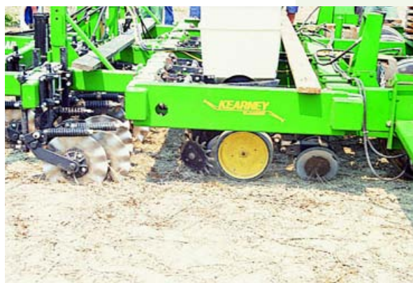
De nombreux adeptes du billonnage travaillent le sol des billons par semis direct avec un système à deux coutres et sarclouse.
