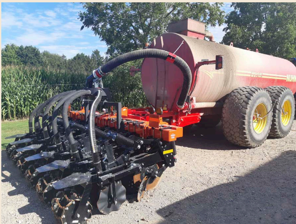
Figure 9. Combinaison de réservoir pour épandre le fumier et d'équipement pour travailler le sol en bandes utilisée par un agriculteur ontarien pour incorporer du fumier liquide.
