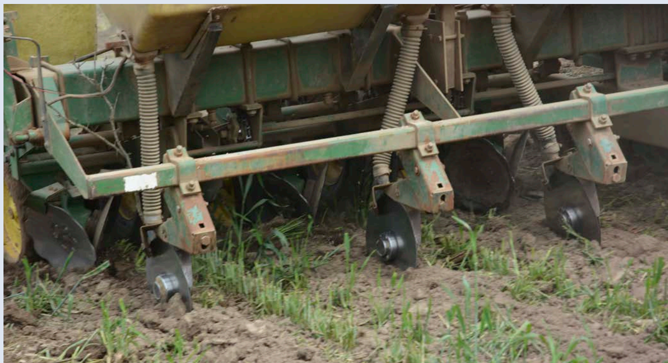
Figure 13. Planteur ontarien équipé pour le travail du sol en bandes. Des ouvreurs à engrais aident le planteur à rester centré sur les bandes molles.
