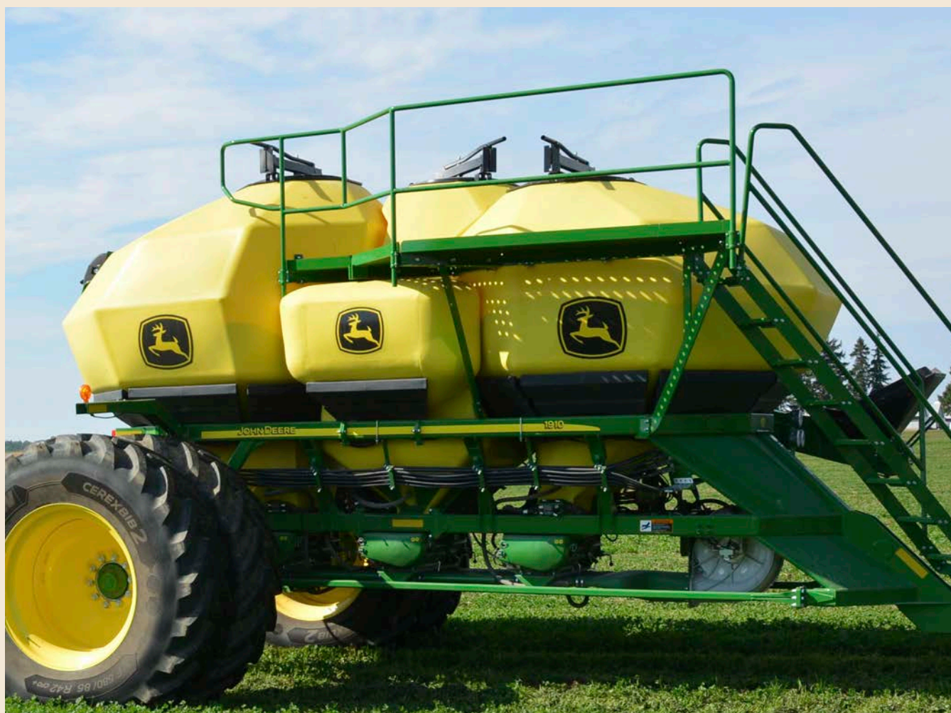
Figure 8. Des chariots à plusieurs cellules pourraient permettre un placement plus profond et plus sûr de l'azote pour les cultures et des placements séparés d'autres éléments nutritifs mélangés dans toute la bande.
