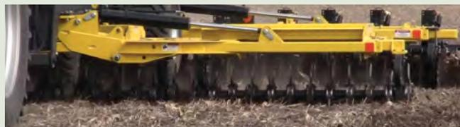
**INSTRUMENTS ARATOIRES ROTATIFS** – Un instrument aratoire rotatif (p. ex. Aerway) est un outil de labour ou de travail superficiel du sol avec paillage pour les sols légers. Il comprend une seule barre d'outils dotée de lames rotatives non motorisées. Le montant est assez lourd pour qu'on puisse y ajouter des poids.
