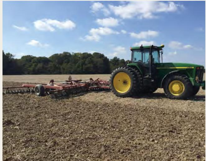
Le travail du sol conventionnel ne laisse aucun résidu à la surface, augmentant le risque d'érosion et de ruissellement (avec phosphore). Utilisant des instruments comme les chisels ou les charrues à chisels et disques ou à disques, le travail du sol avec paillage ne travaille pas le sol aussi finement et enfouit moins de résidus.
