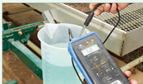
Une analyse régulière de la CÉ et du pH de l'eau d'irrigation et des substrats de culture permet de prévenir les problèmes de carences nutritionnelles.
