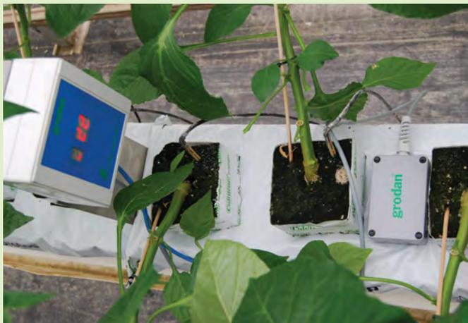
*Des appareils de mesure de la teneur en eau peuvent fournir des données qui permettront d'améliorer l'efficacité de l'irrigation.*
