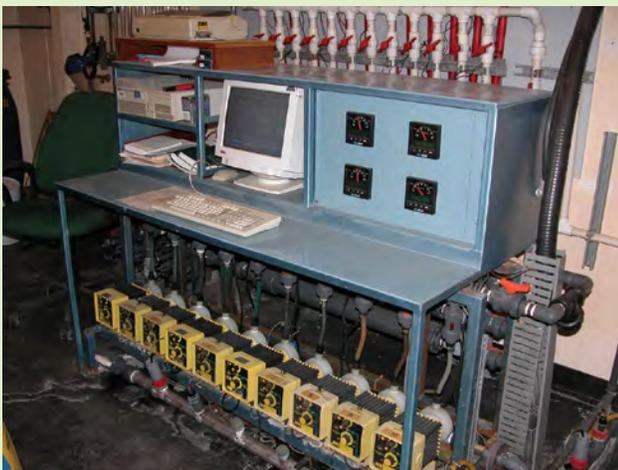
*Les systèmes utilisant un injecteur à têtes multiples permettent au gestionnaire de moduler l'application de fertilisants en fonction des besoins de la culture, selon les résultats d'une analyse hebdomadaire des solutions.*
